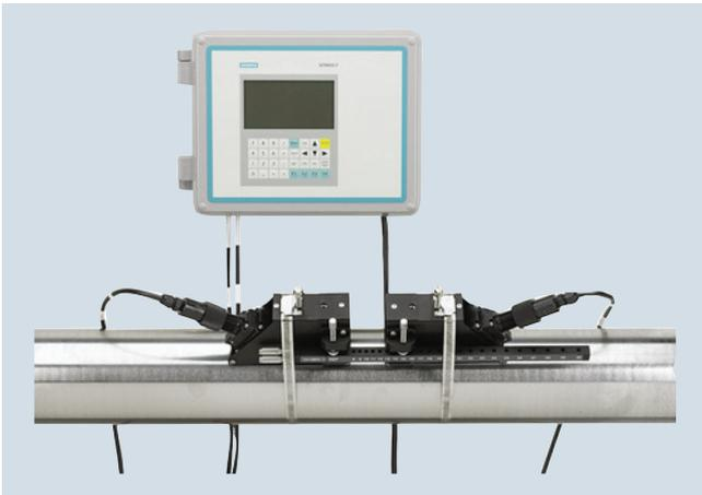
Beim SITRANS FUS1010 handelt es sich um den vielseitigsten derzeit verfügbaren Clamp-on-Ultraschall-Durchflussanzeigemessumformer. Dadurch, dass er sowohl im WideBeam-Laufzeitmodus als auch im Reflexor-Modus (Doppler-Modus) arbeiten kann, eignet er sich für praktisch alle Flüssigkeiten, auch solche mit Lufteinschlüssen oder Schwebstoffen.
