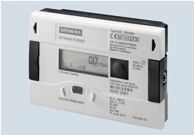
SITRANS FUE950 ist ein universell einsetzbarer Wärmeenergierechner gemäß DIN EN 1434 mit Zulassung nach MID und PTB K7.2 für Wärmeenergiemessungen beim Medium Wasser.
